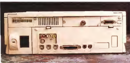
Sul retro della macchina troviamo le connessioni standard e quelle relative alle schede aggiuntive.
